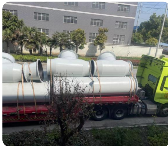
脱硫浆液循环管道
