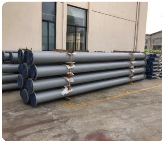
镍钴矿浆输送管道
