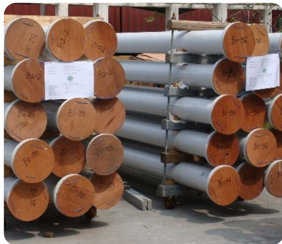
脱硫浆液管道
