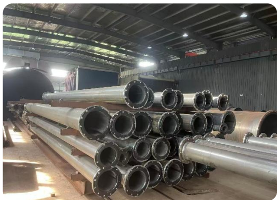
磷酸矿浆耐磨衬胶管道
