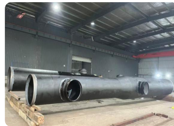
脱硫衬胶喷淋管道
