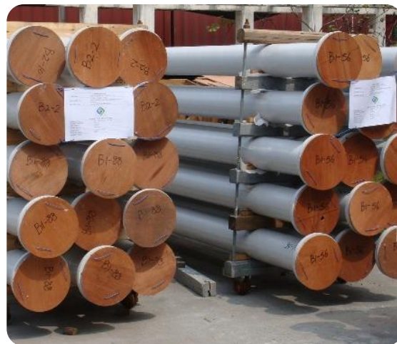
脱硫浆液管道（喷淋部位耐磨）
