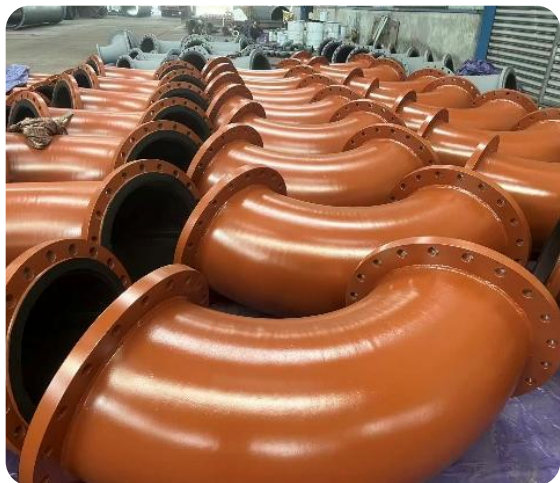
磷酸矿浆输送耐磨管件
