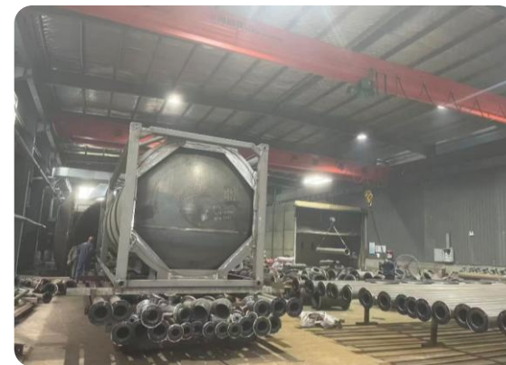
衬胶运输储罐
